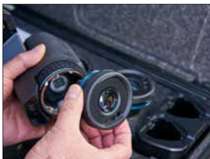
Сменные объективы (от широкоугольных до телеобъективов) для всего «парка» камер за счет применения оптики AutoCal™
