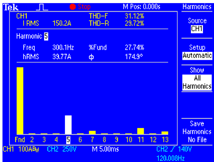
Измерение гармонических искажений с помощью ПО TPS2PWR1.
