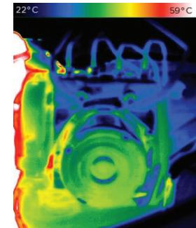
Позволяет установить определенный диапазон температур и его среднее значение, который будет отображаться на экране.
