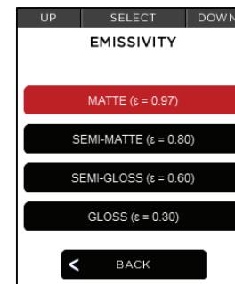
Коэффициент излучения определяет для конкретного типа поверхности как она отражает волны в инфракрасном спектре. Установите один из 4-х предустановленных коэффициентов для более точного определения температуры.
