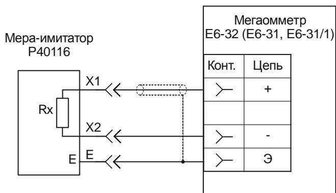
Рисунок 31 - Схема проверки погрешности при измерении сопротивления изоляции
