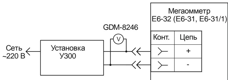
Рисунок 30 - Схема проверки погрешности при измерении напряжения
