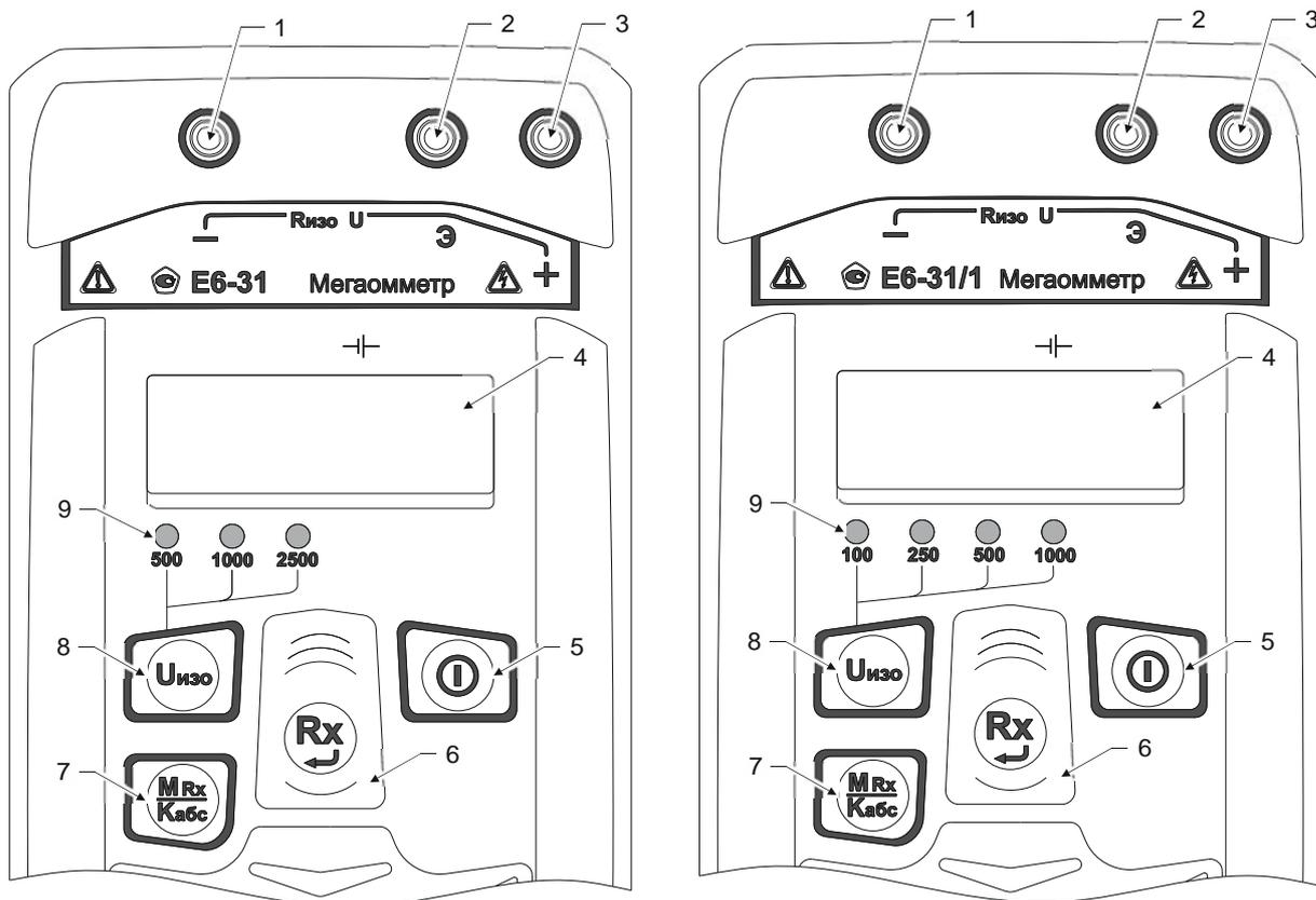
Рисунок 4 - Расположение разъёмов
