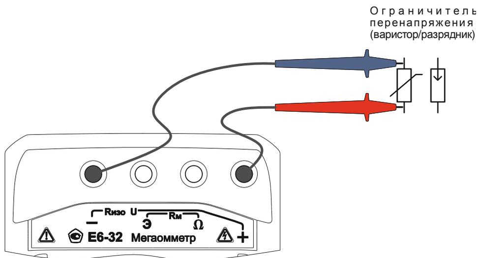
Рисунок 24 - Измерение классификационного напряжения или напряжения пробоя разрядников
