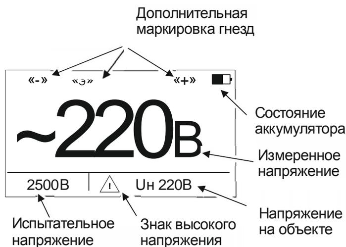
Рисунок 14 - Измерение напряжения
