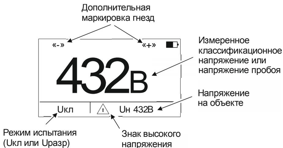
Рисунок 25 - Измерение квалификационного напряжения или напряжения пробоя разрядника
