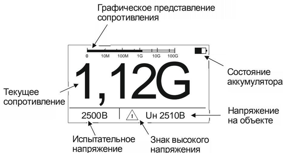
Рисунок 19 - Результат измерения сопротивления изоляции
