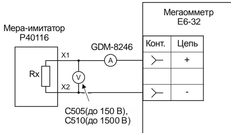
Рисунок 32 - Схема проверки погрешности при измерении квалификационного напряжения
