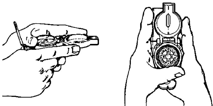
Чтобы измерить азимут, просто поверните свое тело в сторону объекта, указывая крышкой компаса непосредственно на этот объект. Когда вы укажете на объект, посмотрите на циферблат компаса и прочтите значение азимута под неподвижной линией-указателем.
