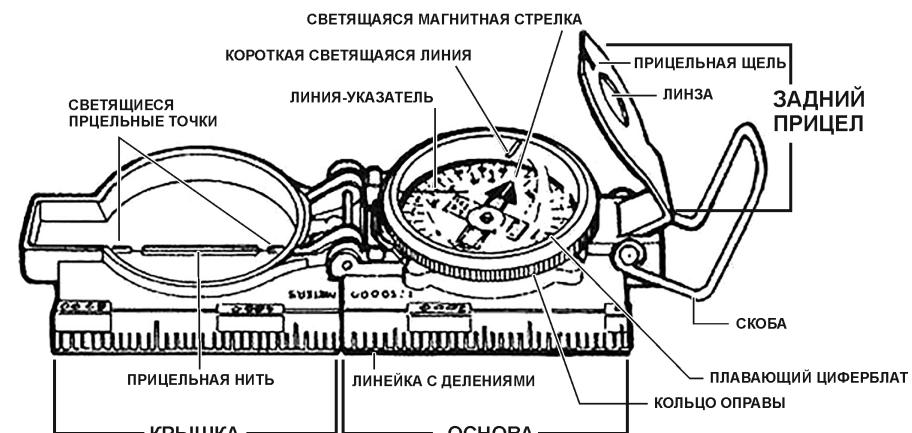
Линза заднего прицела используется для чтения цифровых значений с плавающего диска. Для этого имеется прицельная щель на самом прицеле и прицельная нить на крышке компаса. Навигация и чтение величин осуществляется совмещением прорези прицела, прицельной нити и объекта на местности.
