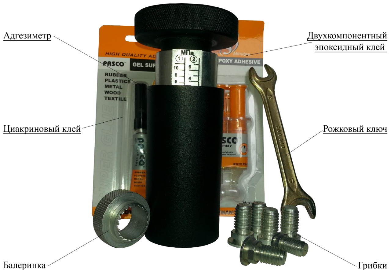
Рисунок 1.1 – Прибор и комплектующие
