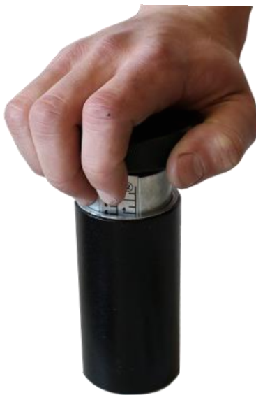
Рисунок 2.4 – Процесс отпускания захватного механизма
