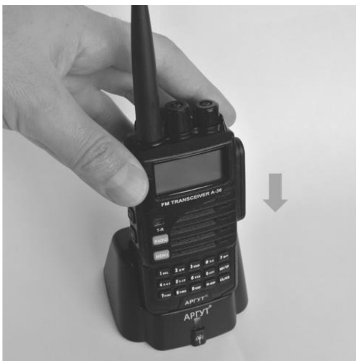
Рис. 6. Установка радиостанции на зарядную базу.
