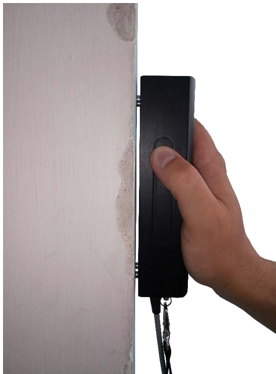
Рисунок 2.5 – Установка преобразователя на поверхность контролируемого объекта
