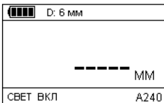
Рисунок 2.3 – Вид дисплея в основном режим работы
