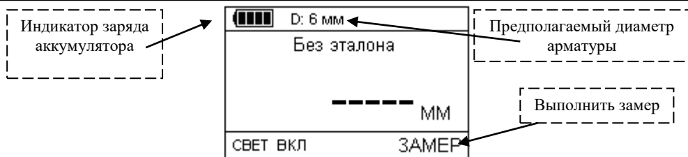
Рисунок 2.10 – Выполнение замера без применения эталонного образца
