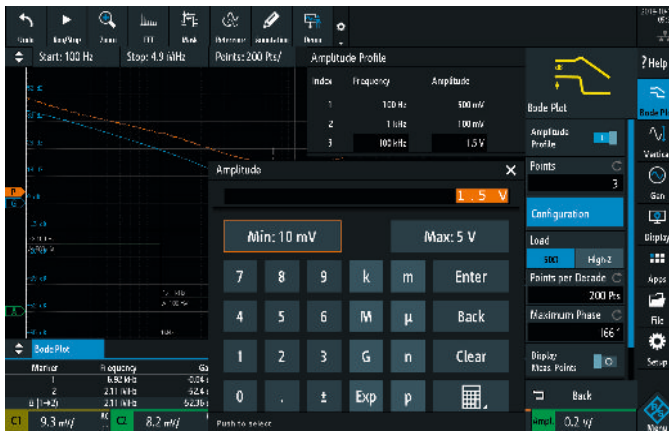
Выходной уровень амплитуды сигнала генератора может варьироваться во время измерения для подавления характеристик помех ИУ
