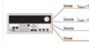
Измерительные входы позволяют компенсировать падение напряжения на соединительных кабелях за счет измерения непосредственно на нагрузке.
