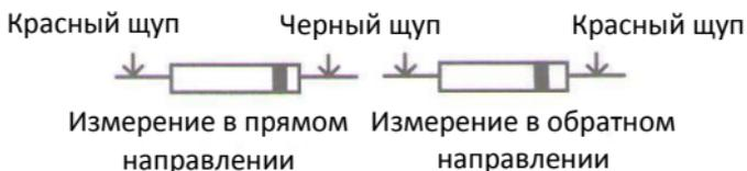
Если в режиме проверки на обрыв сопротивление цепи составляет ниже 150 Ом, срабатывает звуковой сигнал.
