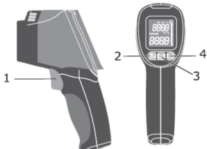
1 – рычаг измерения (прибор автоматически выключается примерно через 15 минут бездействия)
