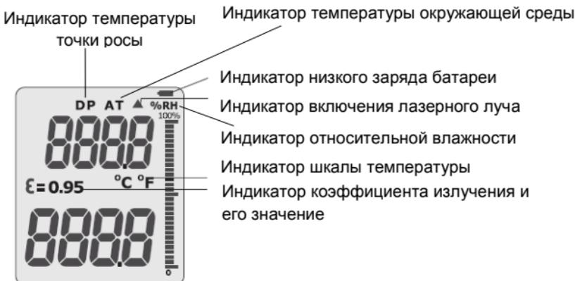
После включения прибор показывает температуру окружающей среды, влажность и температуру точки росы в верхнем поле ЖК-экрана и температуру поверхности измерения в нижнем поле ЖК-экрана. Нажать кнопку MODE для переключения режимов
