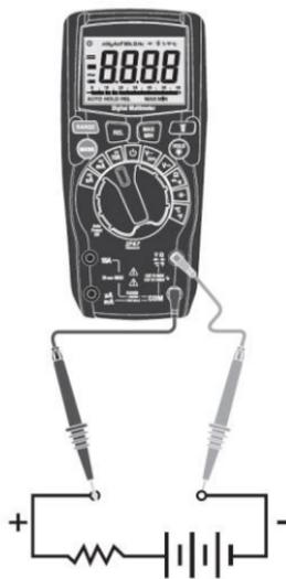
6. Нажмите кнопку **MODE**, чтобы выбрать режим измерения постоянного или переменного тока. На экране появления индикатор **AC «~»** или **DC «—»**.
