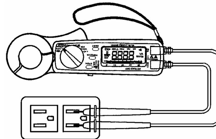
**ВНИМАНИЕ:** Максимальное входное ПОСТОЯННОЕ НАПРЯЖЕНИЕ 1000 В и ПЕРЕМЕННОЕ НАПРЯЖЕНИЕ 750 В. Не пытайтесь измерить более высокое напряжение. Превышение этих пределов может привести к электрическому шоку или повредить прибор.
