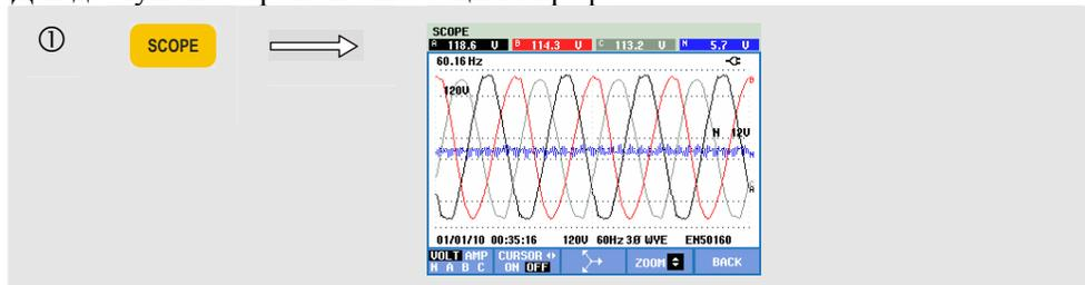
На экране Волна осциллографа отображение кривых напряжения и/или тока осуществляется как на осциллографе, с высокой скоростью обновления. В заголовке экрана при этом показаны соответствующие среднеквадратичные значения напряжения/тока (среднеквадратичные величины 10/12 периодов или 150/180 периодов). Одновременно отображаются четыре периода осциллограммы. Канал A (L1) является эталонным.
