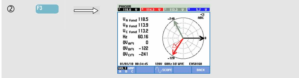
Экран фазора показывает фазовое взаимоотношение между величинами напряжения и тока в виде векторной диаграммы. Вектор эталонного канала А (L1) указывает в положительном горизонтальном направлении. Дополнительными числовыми величинами являются основное фазовое напряжение и/или ток, частота и углы фазы. В заголовке экрана отображаются среднеквадратичные величины напряжения и/или тока.
