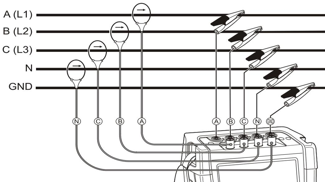
**Рис. 6-2 Подключение анализатора к 3-фазной системе электроснабжения**
