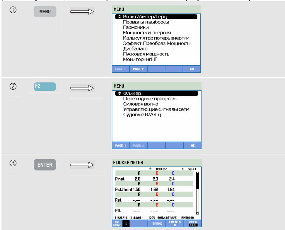
Мерцание имеет следующие характеристики: мгновенное мерцание Pinst, кратковременная интенсивность Pst (измеряемая за 1 мин для быстрого получения данных), кратковременная интенсивность Pst (измеряемая за 10 мин) и долговременная интенсивность Plt (измеряемая за 2 часа). Также производится измерение сопутствующих данных, в том числе среднеквадратичное значение на пол-цикла для напряжения ( $V_{rms} \frac{1}{2}$ ), тока ( $A_{rms} \frac{1}{2}$ ) и частоты.
