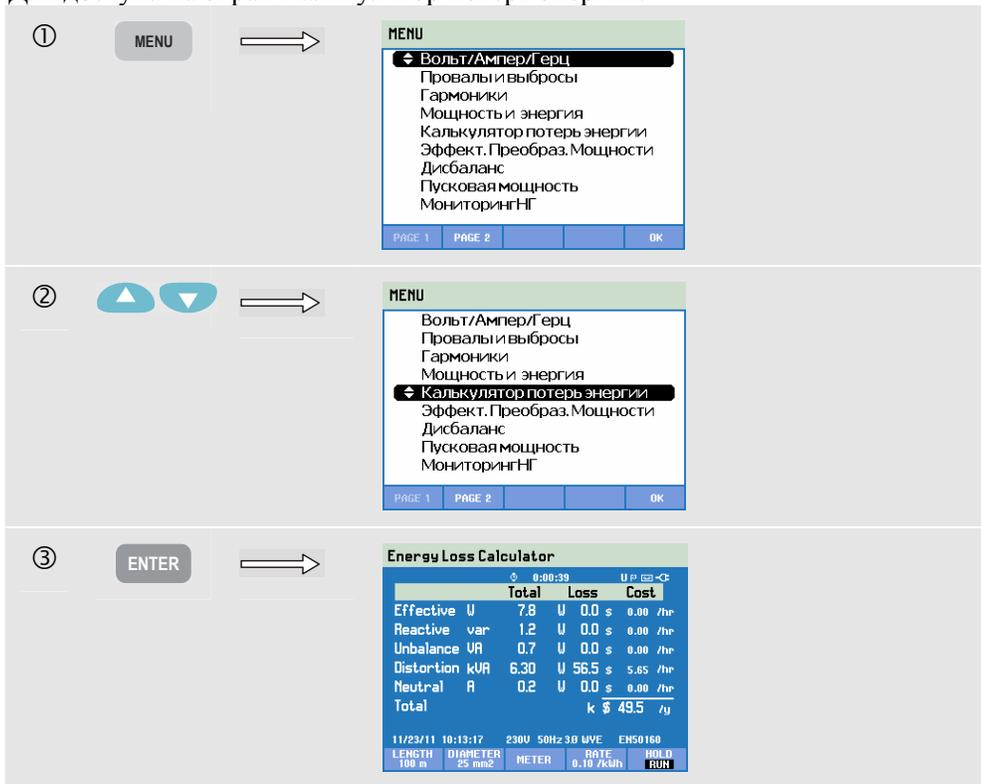
Свойства кабелей, тариф и валюту можно установить заранее при помощи следующей последовательности клавиш - SETUP (настройка), F4 – MANUAL SETUP (ручная настройка), F3 – FUNCTION PREF (настройки функций) и F4 – ENERGY LOSS (потери энергии). Порядок действий описывается в главе 24 - Настройка.
