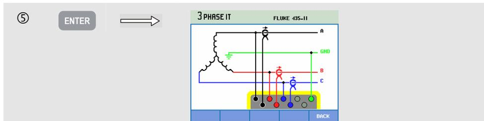
На схеме в деталях показан порядок присоединения датчиков напряжения и тока к испытуемой энергетической системе.
