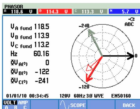
Рис. 6-3 Векторная диаграмма для правильно подключенного анализатора
