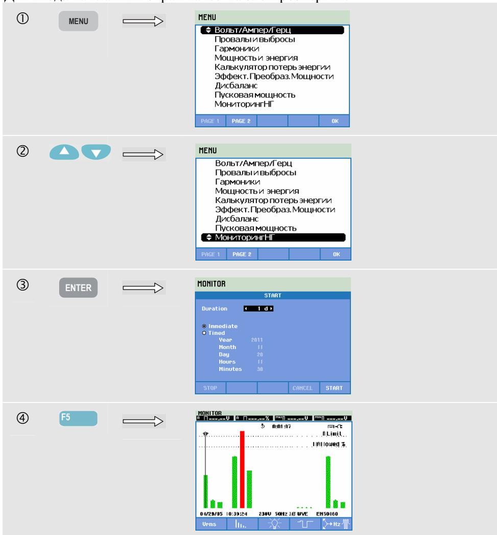
Выход в режим Контроль качества электроэнергии осуществляется с помощью выбора MONITOR (монитор) под клавишей MENU (меню). Меню запуска позволяет выбрать немедленный пуск или пуск по таймеру. Для размещения курсора на конкретной гистограмме используйте клавиши со стрелками влево/вправо. Данные измерения, относящиеся к конкретному столбцу, выводятся в заголовок экрана.
