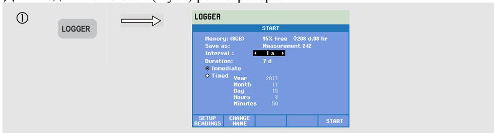
Перечень показаний, подлежащих регистрации, выбирается в меню, раскрываемом функциональной клавишей F1 - SETUP READINGS. Выборка показаний для частоты по умолчанию (50/60 Гц) отличается от показаний для частоты 400 Гц. При изменении частоты на 400 Гц или с 400 Гц на 50/60 Гц происходит сброс выборки показаний до значений по умолчанию.
