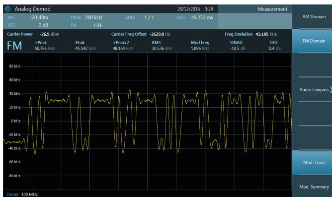
Опция R&S®FPC-K7: анализ ЧМ-модуляции
