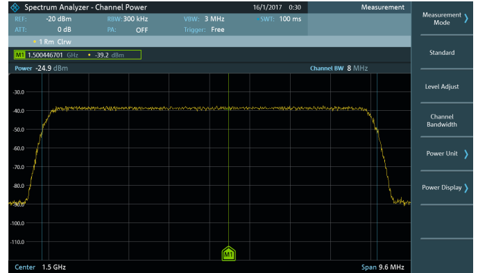
Опция R&S®FPC-K55: измерение мощности в канале
