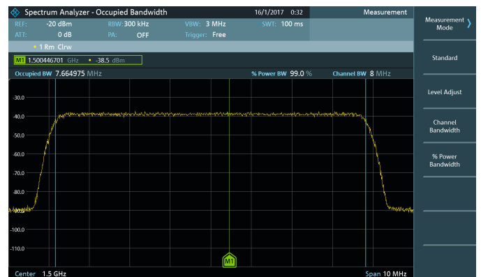
Опция R&S®FPC-K55: измерение занимаемой полосы частот
