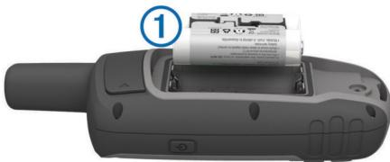
**ПРИМЕЧАНИЕ.** при использовании устройств 64sc в режиме камеры не рекомендуется использовать стандартные щелочные элементы питания.
