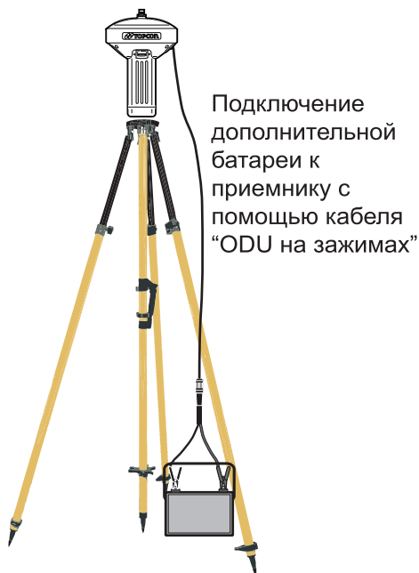
Рис. 2-16. Подключение дополнительной батареи к приемнику
