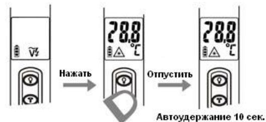
Если на включенном приборе удерживать кнопку в течении 3 сек., тестер автоматически перейдет в режим непрерывного измерения температуры.
