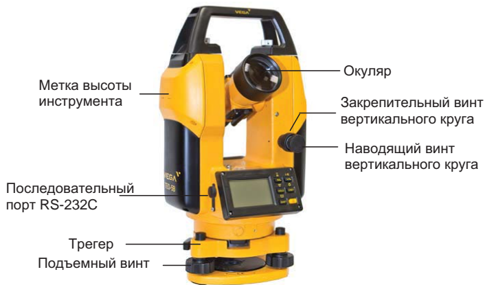
Рис. 3 Части прибора (круг Лаво)
