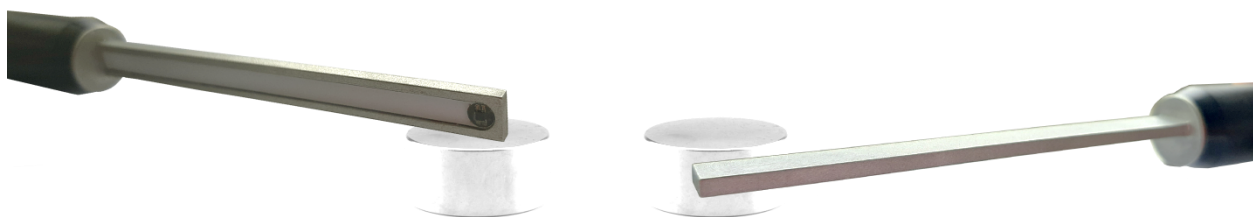
Рисунок 2.15 – Измерение тангенциальной составляющей вектора индукции магнитного поля на торцевой и боковой поверхности изделия
