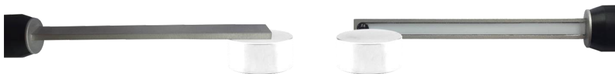
Рисунок 2.14 – Измерение нормальной составляющей вектора индукции постоянного магнитного поля на торцевой и боковой поверхности изделия
