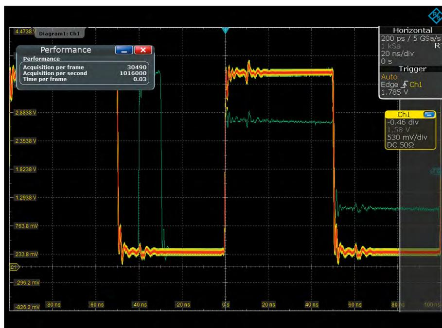
Благодаря высокой скорости сбора данных – один миллион осциллограмм в секунду – осциллографы R&S®RTE обеспечивают возможность оперативного обнаружения редко возникающих ошибок сигнала
