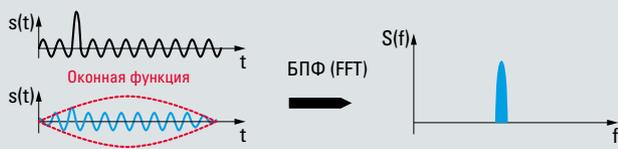
Осциллографы R&S®RTO обеспечивают возможность наложения результатов БПФ и позволяют захватывать низкоамплитудные пики импульсов и использовать цветовую маркировку для их отображения
