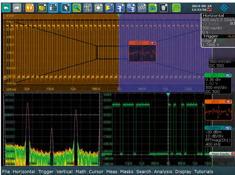
Пользователь может перетаскивать осциллограммы и окна с результатами измерений на экране. Функция SmartGrid компании Rohde & Schwarz помогает пользователям в расположении нескольких диаграмм или таблиц на экране прибора. Размер отдельных диаграмм может быть дополнительно оптимизирован путем перетаскивания границ окна
