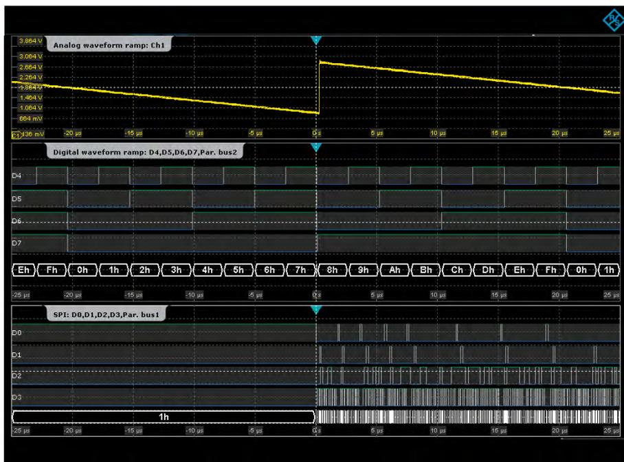
Линейный сигнал 4-разрядного АЦП с аналоговым и цифровыми каналами, а также сигнал шины SPI с цифровыми каналами
