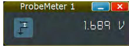
R&S®ProbeMeter: высокая точность измерения постоянной составляющей вне зависимости от настроек прибора и одновременно с проведением измерения канала
