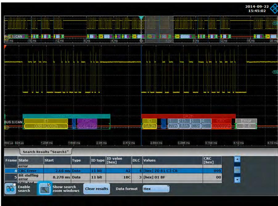
Обнаружение ошибок в данных последовательных протоколов с помощью функции поиска прибора R&S®RTE. Все события сводятся в таблицу, что упрощает навигацию по различным событиям. Для проведения подробного анализа выбранных событий можно воспользоваться функцией масштабирования
