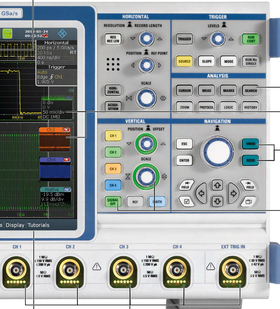
Непосредственный доступ к часто используемым функциям анализа
