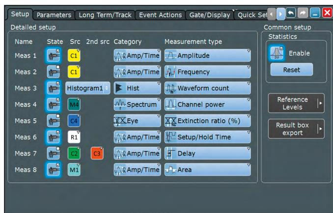
Осциллографы R&S®RTE поддерживают возможность одновременной настройки и использования до восьми автоматизированных измерений
