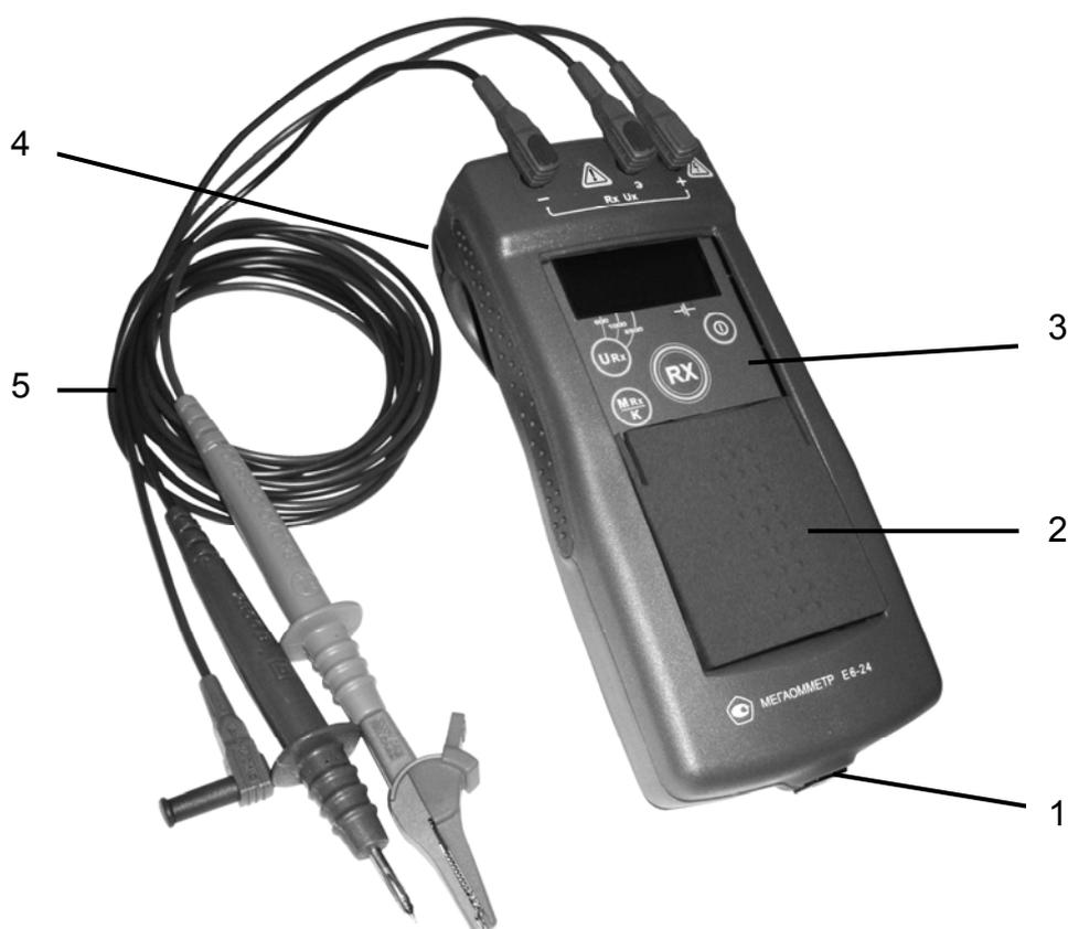
Рисунок 1.5.1 - Внешний вид мегаомметров
