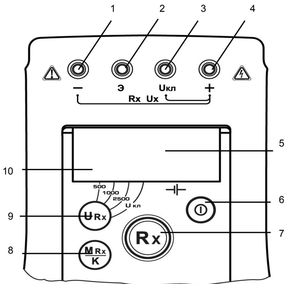
Рисунок 1.5.3 в - Передняя панель мегаомметра Е6-24/2
