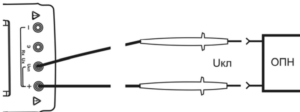
Рисунок 2.1.3 г - Подключение кабелей к мегаомметру Е6-24/2 при измерении классификационного напряжения
