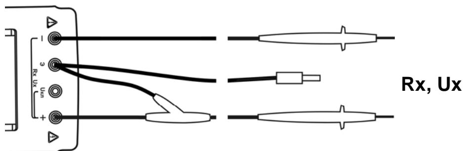
Рисунок 2.1.3 в - Подключение кабелей к мегаомметру Е6-24/2
