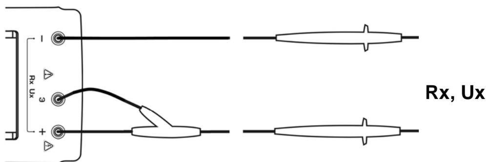
Рисунок 2.1.3 б – Подключение кабеля измерительного экранированного
