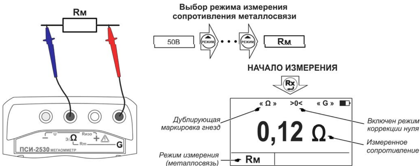
Рисунок 2.8 – Измерение сопротивления металlosвязи
