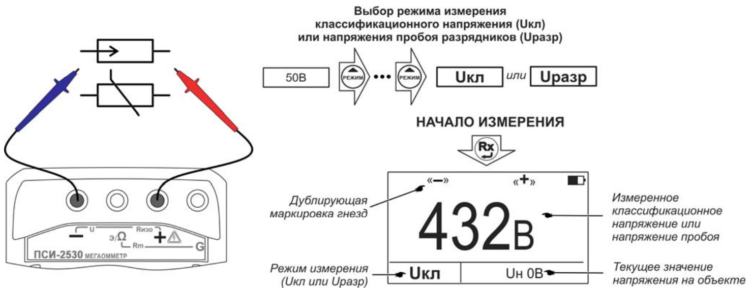
Рисунок 2.10 – Измерение классификационного напряжения или напряжения пробоя разрядников
