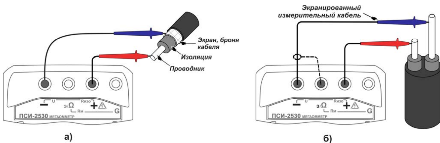
Рисунок 2.5 – Измерение сопротивления изоляции кабеля
