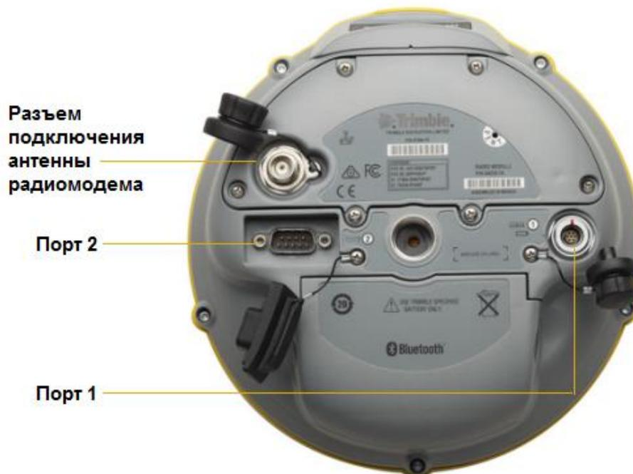
Разъёмы маркируются пиктограммами, обозначающими основное применение разъёма:
