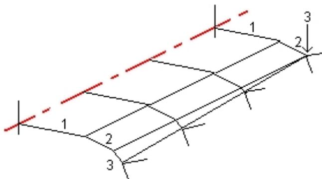
Лучший способ управления процессом интерполяции для максимального соответствия проекту трассы - это добавление секций с нулевым сдвигом.
