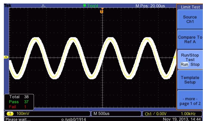
Функция контроля предельных значений обеспечивает быструю разбраковку «годен/не годен», сравнивая входные сигналы с заданными пользователем шаблонами.
