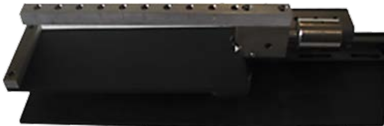
Рисунок 2.1 – Уравновешенное коромысло прибора
