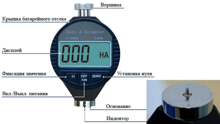
Рисунок 1.1 – Твердомер по Шору NOVOTEST ТШ-Ц
