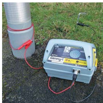
Способ трассировки кабелей малого диаметра
