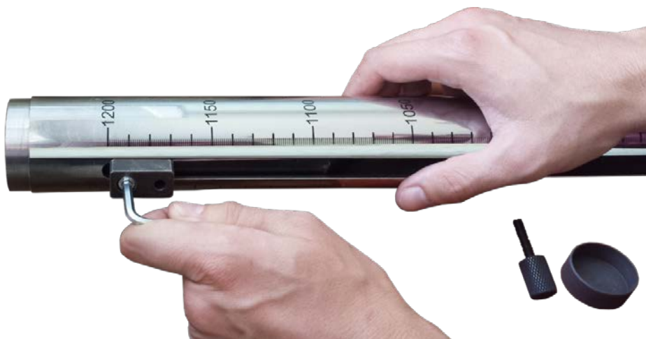
Рисунок 2.1 – Установка ударника внутрь направляющей трубы
