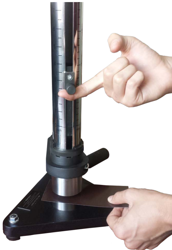
Рисунок 2.2. – Установка пластины для проведения испытания
