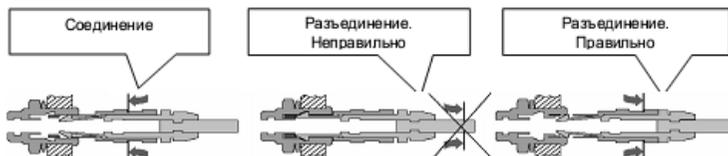
Рисунок 2.3 – Манипулирование разъемами LEMO
