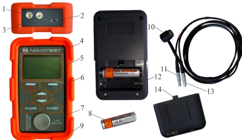
*1 – разъем генератора; 2 – разъем miniUSB; 3 – разъем приемника; 4 – электронный блок; 5 – графический индикатор; 6 – клавиатура; 7 – эталонная мера; 8 – аккумуляторная батарея; 9 – защитный силиконовый бампер; 10 – преобразователь; 11 – штекер генератора; 12 – отсек размещения батареи; 13 – штекер приемника; 14 – крышка отсека размещения батареи.*
