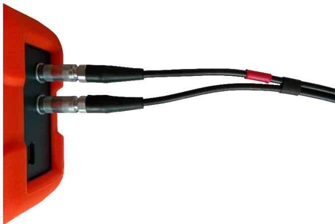
Рисунок 2.1 – Подключение преобразователя
