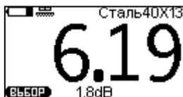
Рисунок 2.11 – Пользовательское регулирование усиления
