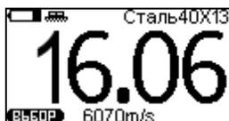
Рисунок 2.13 – Дисплей после проведения измерения
