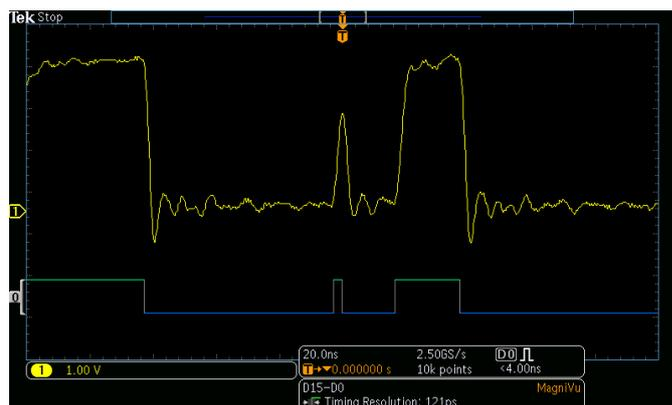
Режим захвата MagniVu обеспечивает разрешение по времени 121,2 пс, позволяя выполнять точные измерения временных характеристик цифровых сигналов.
