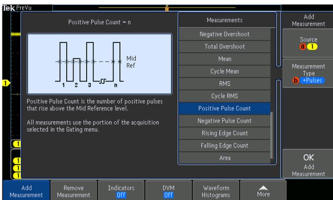
Каждое измерение снабжено текстом и символом для объяснения того, как выполнено измерение.
