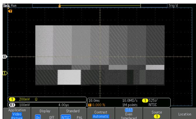
Просмотр изображения испытательной таблицы NTSC "цветные полосы". В режиме просмотра видеоизображений предусмотрены автоматическая и ручная регулировка яркости и контрастности.
