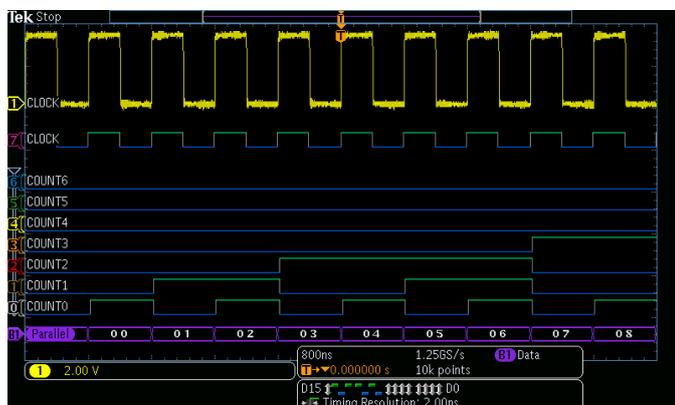
Осциллограф серии MDO3000 с опцией MDO3MSO имеет 16 интегрированных цифровых каналов, позволяющих просматривать и анализировать коррелированные по времени аналоговые и цифровые сигналы.
