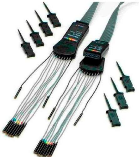
Пробник для цифровых каналов P6316 имеет две группы по восемь контактов каждая, что упрощает подключение к исследуемому устройству.
