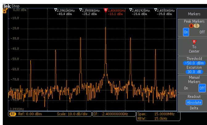
Автоматические маркеры пиковых значений позволяют наглядно представлять важную информацию. На рисунке показаны пять самых высоких амплитудных пиков. Они автоматически обозначены маркерами, поскольку превышают пороговые значения и величину показателя отклонения; для каждого маркера приведены значения пиковой амплитуды и частоты.
