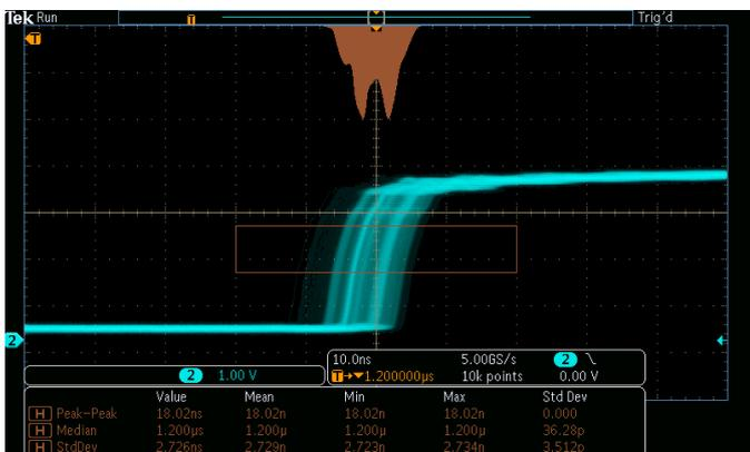
Гистограмма сигнала, построенная по положительному перепаду импульса, помогает оценить распределение положения перепада (джиттер) во времени. На экране отображаются числовые значения результатов измерений, полученные на основе гистограммы.
