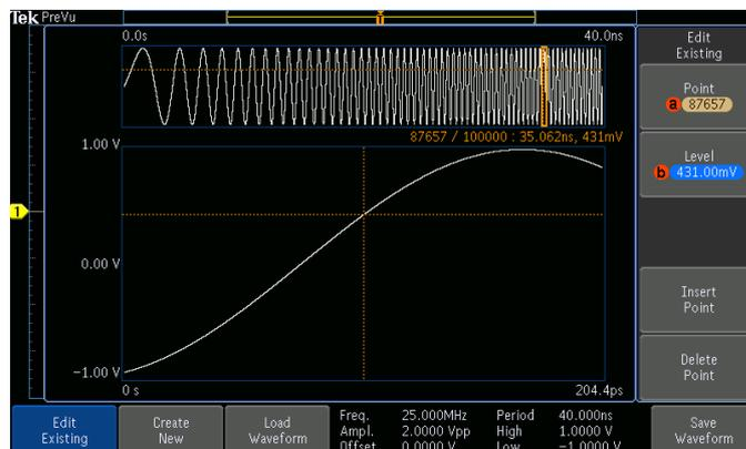
Редактор для поточечного редактирования сигналов произвольной формы
