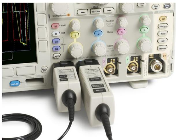
Интерфейс TekVPI® упрощает подключение пробников к осциллографу.
