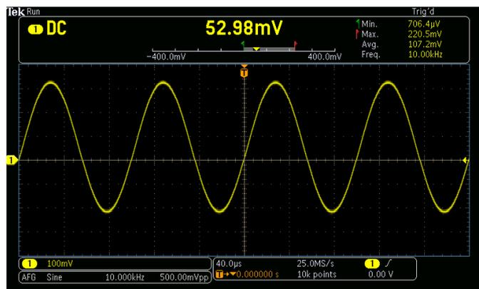
Результаты измерения в течение 5-секундного интервала представлены с указанием минимального, максимального и среднего значений постоянного напряжения. Показана также частота сигнала.
