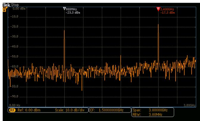
Отображение спектров сигналов пакетной передачи данных, полученных за один захват, на входе и выходе преобразователя протокола Zigbee (900 МГц) в протокол Bluetooth (2,4 ГГц).
