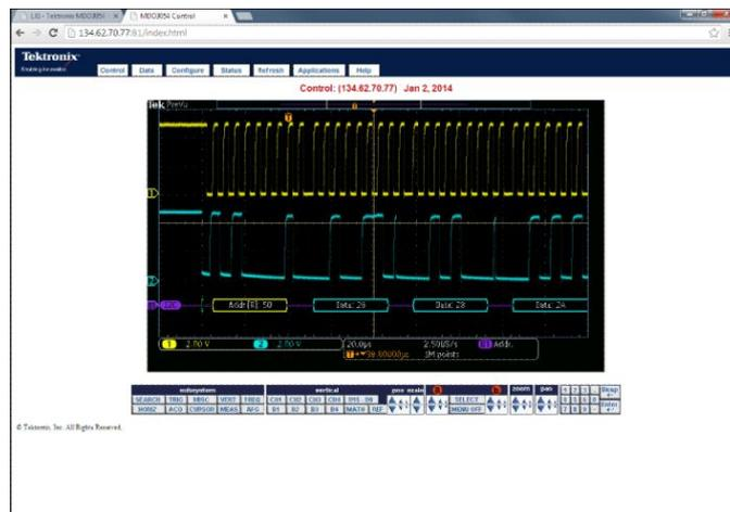
Изображение дисплея осциллографа MDO3000 отображается в обозревателе с помощью ПО e\*Score. Это ПО можно использовать для быстрого документирования проведенных измерений в виде снимков экрана, осциллограмм или настроек, которые могут понадобиться позже.
