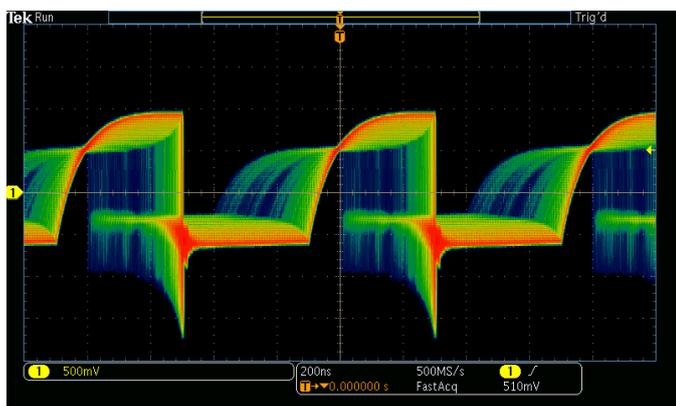
Технология цифрового люминофора с режимом захвата FastAcq поддерживают скорость захвата более 280 000 осциллограмм в секунду и отображение градаций яркости в режиме реального времени.
