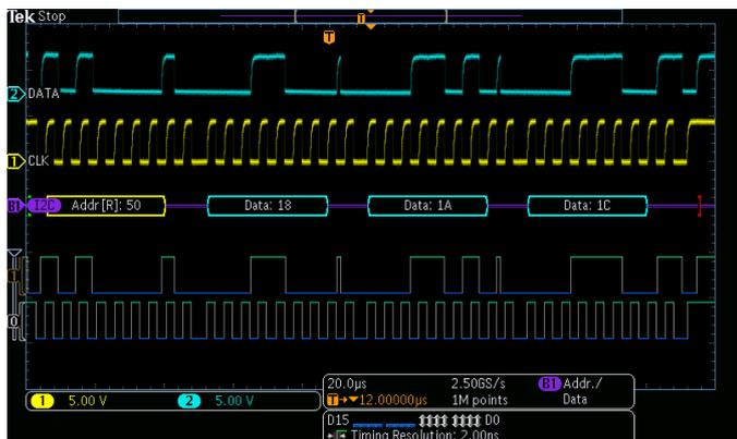
Запуск по конкретному пакету данных, проходящему по шине I<sup>2</sup>C. Желтая осциллограмма представляет собой сигнал тактовой частоты, а синяя – данные. Осциллограмма сигнала шины показывает декодированное содержимое пакета, включая Старт, Адрес, Чтение/Запись, Данные и Стоп.
