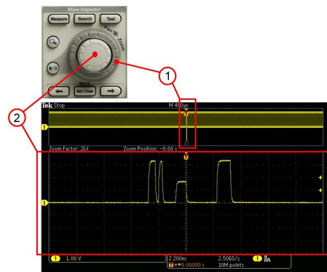
Панель управления Wave Inspector обеспечивает непревзойденную эффективность просмотра, навигации и анализа данных. Поворачивая внешнюю ручку панорамирования (1), можно пролистать все точки записи. Перемещение из начала в конец займет считанные секунды. А если вы увидели нечто интересное и хотите подробнее это рассмотреть? Просто поверните внутреннюю ручку масштабирования (2).
