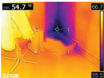
Область с холодным участком указывает на проникновение воздуха
