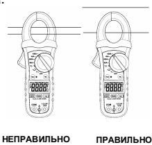
полностью закройте датчик. На ЖК-дисплее будет отображено значение тока.
