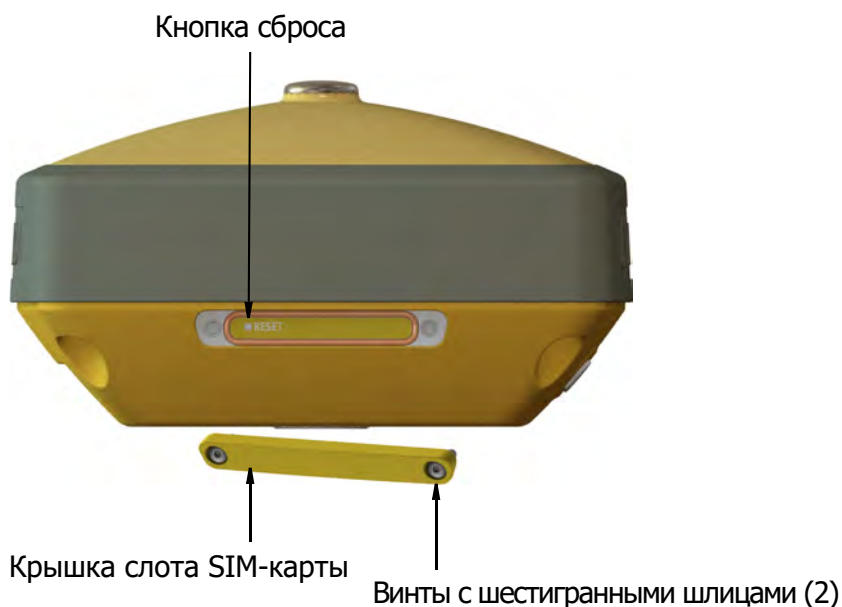
Рисунок 2-5: Удаление крышки слота SIM-карты
