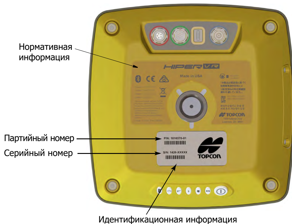
Рисунок 2-6: Обзор нижней части приемника с наклеенной идентификационной и нормативной информацией
