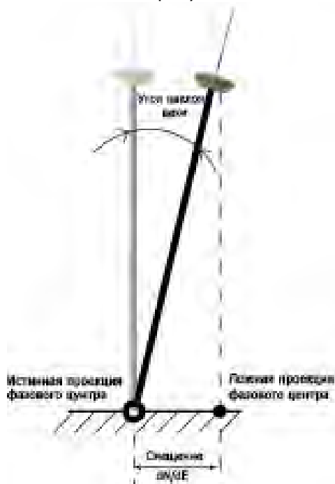
Рисунок 5-12: Режим коррекции наклона Tilt
