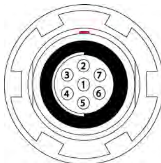
Рисунок 9-2: Разъем последовательного порта RS-232
