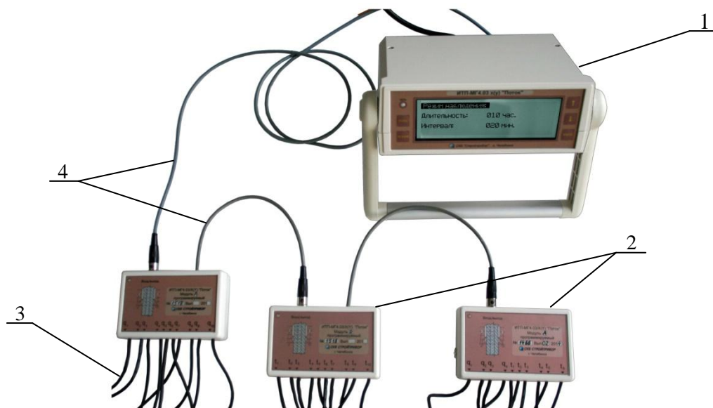
1 – электронный блок; 2 – модули; 3 – кабели датчиков теплового потока и температуры; 4 – соединительные кабели
