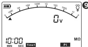
3 Подключите измерительные провода, нажмите кнопку «Тест», прибор начнёт измерение индекса поляризации, зуммер будет периодически издавать звуковой сигнал, при измерении в TIME1 - значок «TIME1» и «PI» мигает, при измерении сопротивления изоляции в TIME2 мигает значок "TIME2" и "PI". 10
