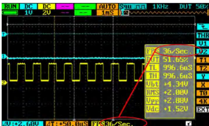
Коротко нажмите кнопку «Измерители» появится окно с 8-ю программируемыми измерителями, каждый из измерителей имеет 12 настроек, одновременно может быть отображено 8 параметров, кроме этого верхний измеритель дублируется в области
