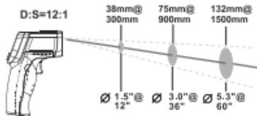
зависимости от размера измеряемого объекта выбирайте расстояние до него.
