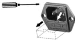
Предохранитель гнезда 2 А находится в гнезде 2А. Для замены необходимо выключить прибор, отключить измерительные щупы, нажать и повернуть гнездо, заменить предохранитель на аналогичный быстродействующий рассчитанный на ток 2А. установить гнездо в обратном порядке.
