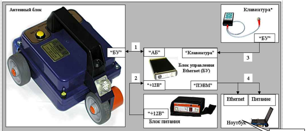
Рисунок 2.3.2. Функциональная схема георадара с ПЭВМ
