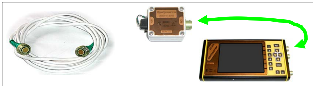
Рисунок 3.3.10. Подключение интерфейсного электрического кабеля к АБ-90, АБ-150, АБ-250, АБ-400, АБ700 и Блоку обработки.
