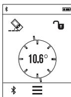
Meranie sklonu slúži na meranie stúpania alebo sklonu (napr. schodov, zábradlia, pri prispôbení nábytku, pri pokladaní rúr atď.).
