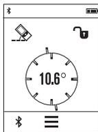
Режим вимірювання кута нахилу слугує для визначення підйому або нахилу (напр., сходових хіднів, поручнів, при підгонці меблів, при прокладанні труб тощо).
