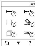
Każdej funkcji pomiarowej towarzyszy w urządzeniu pomiarowym instrukcja w postaci animacji. W pierwszej kolejności należy wybrać przycisk **k**, a następnie pożądaną funkcję pomiarową. Animacja przedstawia dokładny sposób postępowania w danej funkcji pomiarowej.
