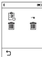
Nakon odabira tipke **h** možete izbrisati cijeli popis izmjerenih vrijednosti ili pojedinačne izmjerene vrijednosti. Pritiskom na tipku **h** izbrisat će se odabrana pojedinačna izmjerena vrijednost.
