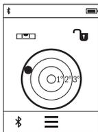
Digitalna libela služi za proveru horizontalnog poravnanja objekta (npr. mašina za pranje veša, frižider itd.) istovremeno u dve ose. Kao referentna ravan za digitalnu libelu služi zadnja strana mernog alata.
