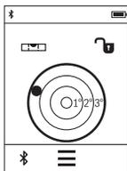
Bolobocul digital servește la verificarea alinierii simultane pe două axe ale unui obiect (de exemplu mașină de spălat, frigider ș. a. m. d.).
