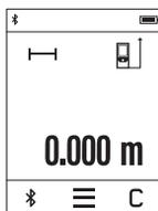
Po zapnutí se měřicí přístroj nachází ve funkci měření délky. Jiné funkce měření můžete nastavit stisknutím tlačítka **k** (viz „Měřicí funkce“, strana 33).
