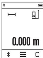
Після увімкнення вимірювальний інструмент знаходиться в режимі вимірювання довжини. Інші режими вимірювання можна налаштувати натисканням на кнопку **k** (див. «Вимірювальні функції», стор. 111).
