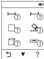
В измерительном инструменте для каждого режима измерения имеется помощь в виде анимации. Сначала нажмите кнопку **k**, а затем желаемый режим измерения. Анимация показывает подробный способ действия для выбранного режима измерения.
