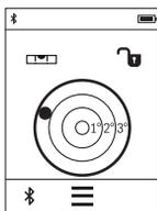
Digitaalne vesilood on ette nähtud eseme horisontaalseks nivelleerimiseks üheaegselt kahel teljel (nt pesumasin, külmkapp jmt). Digitaalse vesiloodi lähtetasandiks on mõõteseadme tagakülg.
