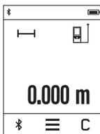
След включване измервателният уред се намира в режим за измерване на дължини. Можете да включите други режими на измерване чрез натискане на бутона **k** (вижте „Режими на измерване“, страница 169).
