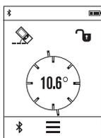
Измерването на наклон служи за измерване на ъгъл на наклонени повърхности или мислени прави (напр. на стълби, парапети, сводове за мебели, при прекарване на тръби и др. п.). Като отправна равнина при измерването на наклон служи лявата страна на измервателния уред. Ако на дисплея не се показва символа за наклон, по време на измерването уредът е бил наклонен странично твърде много.
