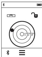
Digitalna libela služi za provjeru horizontalnog niveliranja nekog predmeta na dvije osi istodobno (npr. perlice rublja, hladnjaka itd.). Kao referentna ravnina za digitalnu libelu služi stražnja strana mjernog alata.
