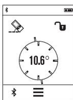
Mjerenje nagiba služi za mjerenje nagiba (npr. stepenica, ruko-hvata, kod montaže namještaja, kod polaganja cijevi itd.). Kao referentna ravnina za mjerenje nagiba služi lijeva strana mjernog alata. Ako se na displeju ne prikaže kut nagiba, tada je mjerni alat za vrijeme mjerenja previše bočno nagnut.
