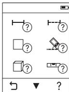
Измервателният уред има анимирана помощ за всеки режим на измерване. Първо изберете бутона **k**, а след това желания режим на измерване. Анимацията показва подробно стъпките за избраната функция.
