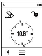
Měření sklonů slouží k měření stoupání nebo klesání (např. schodišť, zábradlí, při přizpůsobování nábytku, při pokládání trubek atd.).
