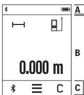
Zaslon je podijeljen u područja: na statusnu traku (A) i displej osjetljiv na dodir (B) s trakom izbornika (C). Statusna traka prikazuje *Bluetooth*®-stanje veze, upozorenje za temperaturu te stanje punjenja baterija/aku-baterija. Pomoću displeja osjetljivog na dodir možete upravljati mjernim alatom bez dodirivanja tipki.
