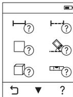
У вимірювальному інструменті для кожного режиму вимірювання є допомога у вигляді анімації. Спочатку натисніть на кнопку **k**, а потім на бажаний режим вимірювання. Анімація демонструє докладний порядок дій для обраного режиму вимірювання. Анімацію можна в будь-яку мить зупинити і розпочати знову. Її можна прокручувати вперед і назад.
