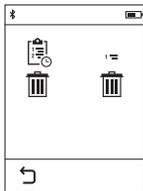
Натисненням кнопки **h** можна видалити весь список або окремі виміряні значення. Натисненням кнопки **h** можна видалити обране на той час окреме вимірне значення.
