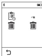
A **h** gomb kijelölése után a teljes mérési érték listát vagy egyedi mérési értékeket lehet kitörölni. A **h** gomb megnyomásával a mindenkor kijelölt egyedi mérési érték törlésre kerül.
