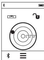
Digitalna tehtnica se uporablja za preverjanje istočasne vodoravne poravnosti objekta na dve osi (npr. pralnega stroja, hladilnika itd.).
