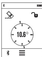
Măsurarea înclinării servește la măsurarea unei pante sau înclinării (de exemplu a scârilor, balustradelor, potrivirea pieselor de mobilier, la montarea țevilor, ș. a. m. d.).
