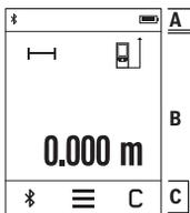
A kijelző az állapotsorok területére (A) és a menüsort (C) is tartalmazó érintős képernyőre (B) osztható fel. Az állapotsor a *Bluetooth*® összeköttetés státuszát, a hőmérsékleti figyelmeztetést, valamint az elemek/akkumulátorok töltési szintjét mutatja. Az érintős képernyőn a mérőműszert a gombok megérintésével lehet vezérelni.
