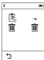
Po výbere tlačidla **h** môžete vymazať celý zoznam nameraných hodnôt alebo jednotlivé namerané hodnoty. Stlačením tlačidla **h** sa vymaže príslušná vybraná nameraná hodnota.
