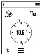
Мерењето на косини служи за мерење на нагорници и надолници (на пр. на скали, гелендери, при вклопување на мебел, при положување на цевки итн.).
