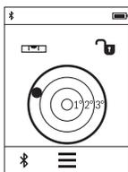
Digitálna vodováha slúži na kontrolu horizontálneho alebo vertikálneho centrovania objektu na dvoch osiach súčasne (napr. práčky, chladničky atď.).
