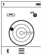
Дигиталната васер-вага служи за проверка на хоризонталното израмнување истовремено на две оски на еден објект (на пр. машина за перење, фрижидер итн.).
