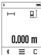
Po włączeniu urządzenie automatycznie ustawia się w funkcji pomiar długości. Pozostałe funkcje pomiarowe można wybrać za pomocą przycisków **k** (zob. »Funkcje pomiaru«, str. 15).
