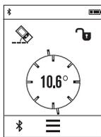
A lejtésmérés (például lépcsők, korlátok, egymáshoz illesztendő bútorok, csövek lefektetések stb.) egy menetemelkedés vagy lejtés mérésére szolgál.
