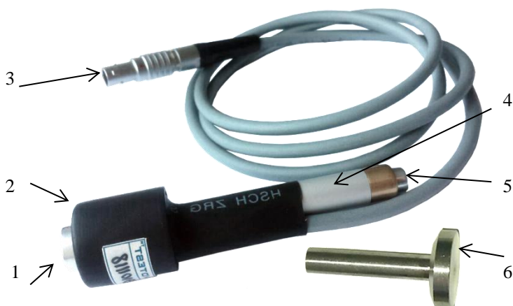
1 – боек; 2 – катушка индуктивности; 3 – штекер; 4 – корпус; 5 – спусковая кнопка; 6 – взводной толкатель.
