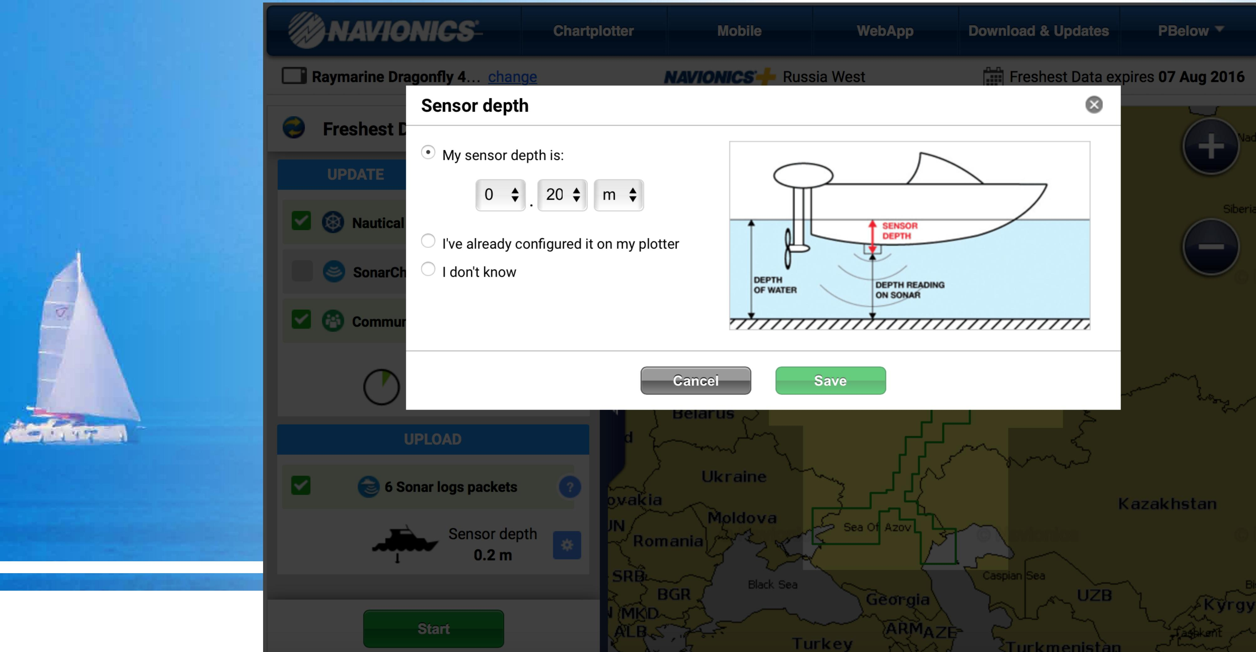
Вы можете указать величину заглубления датчика эхолота относительно ватерлинии, эта поправка будет учитываться при отображении глубины на экране картплоттера. А также с этой поправкой будут записываться сонар-логи.
