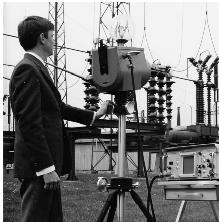
1969 г.: модель Thermovision 661. Камера весила примерно 25 кг, осциллограф — 20 кг и штатив — 15 кг. Оператору также требовалась генераторная установка на 220 В переменного тока и сосуд на 10 л с жидким азотом. Слева от осциллографа находится фотоприставка Polaroid массой 6 кг.
