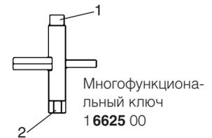
После удаления колпачка, перекрытия вентилей ГЕПЦ-RL-5 с помощью многофункционального ключа поз.1 (момент вращения 5...8 Нм) и перекрытия вентилей на прямом потоке (термостатическая головка в положении „0“) можно опорожнять отопительный прибор во время работы системы.
