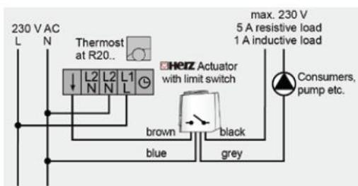
Рекомендуется использование кабелей для подключения к сети на 230 В: кабель с изоляцией проводников из поливинилхлорида NYM с сечением проводников 1,5 мм<sup>2</sup> или плоским кабелем NYIF с сечением проводников 1,5 мм<sup>2</sup>.
