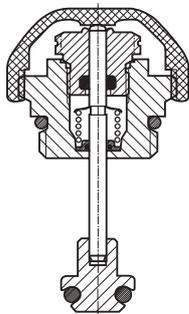
Для регулировки термостатических буксы могут применяться все термоголовки ГЕРЦ с дистанционным управлением, а также компоненты электронной регулирующей системы ГЕРЦ-RTC (электронный регулятор температуры, приводы DDC) и ГЕРЦ-RTR (комнатные термостаты, термомоторы).
