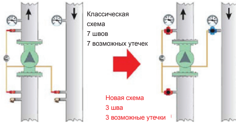
Классическая схема: запорный и сливной клапаны
